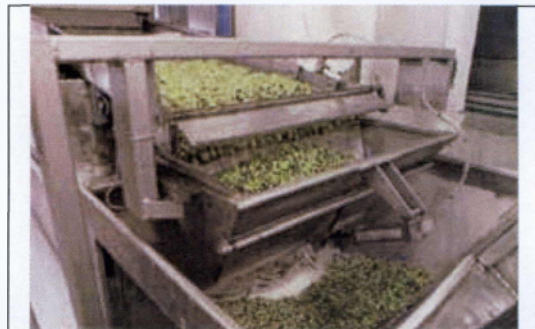
Εικόνα 7.1. Μεταφερόμενος ελαιοκάρπος που πλένεται σε ελαιουργείο.
