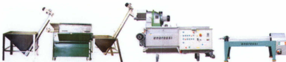
Εικόνα 23: Πλήρες ελαιοτριβείο της ιταλικής Enoagricola Rossi με χοάνη παραλαβής και αποφυλωτή, πλυντήριο, αναβατήριο, αλεστικό, διαχωριστή και αντλία εκφόρτωσης των αποβλήτων
