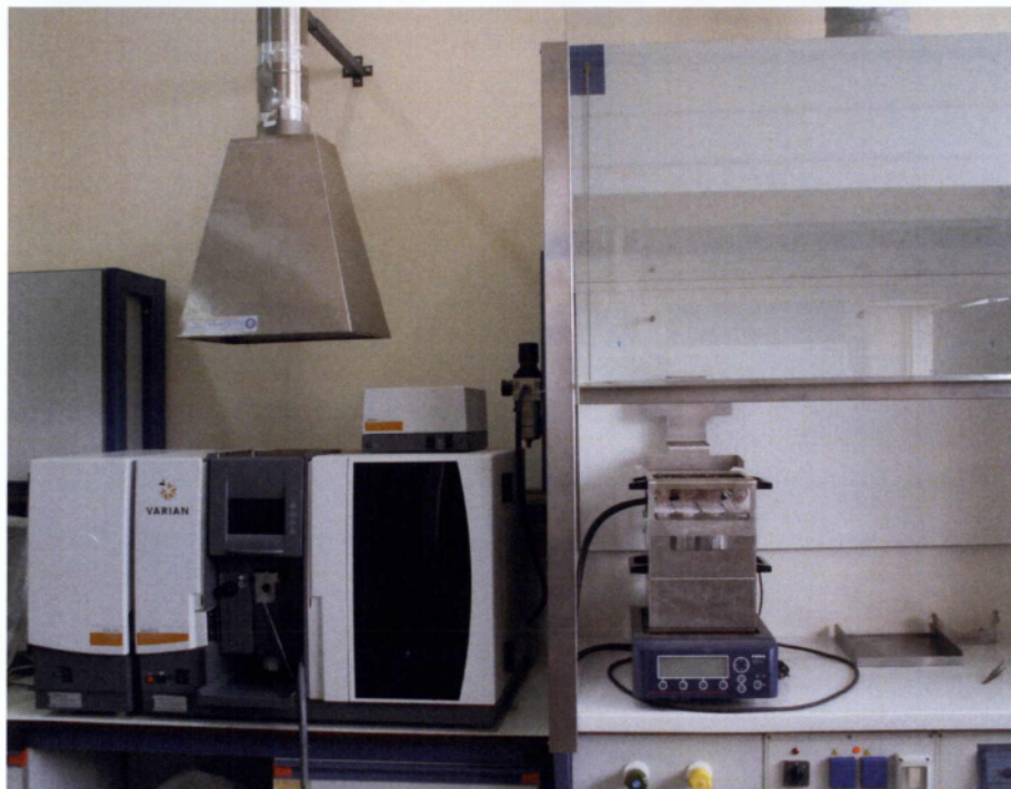
Φωτογραφία 4. Σpektροφωτόμετρο Ατομικής Απορρόφησης (αριστερά), Συσκευή Υγρής Καύσης (δεξιά)
