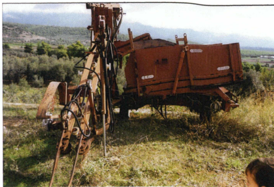
Εικόνες 9. - 9.1. : Μηχανές συγκομιδής καρότου / πράσου μιας σειράς
