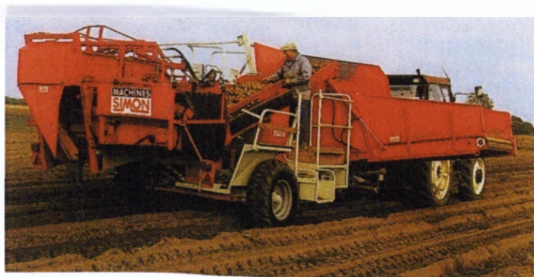
Εικόνες 4, 4.1. : Μηχανές συγκομιδής πατάτας 3,3 τόνων, ισχύς 60HP
