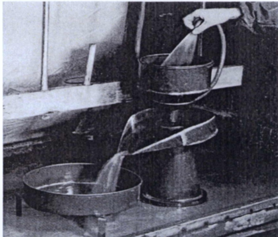
Εικόνα 3.2 Η συσκευή Fenwick που χρησιμοποιείται για την απομόνωση κύστεων από εδαφικά δείγματα.
