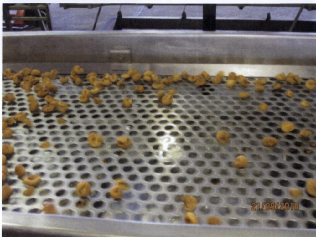
Εικόνα 17: Ταξινόμηση σύκων κατά μέγεθος σε δονούμενο κόσκινο (άνω) και λεπτομέρεια του καλιμπραδόρου (κάτω).
