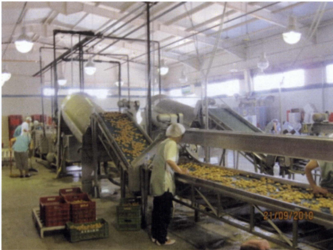
Εικόνα 18: Τράπεζα ποιοτικής διαλογής με ατέρμονα ιμάντα.
