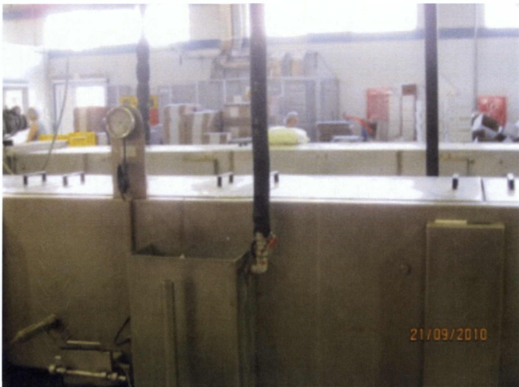
Εικόνα 21: Βραστήρας (καζάνι) ζεματίσματος ξηραμένων σύκων.
