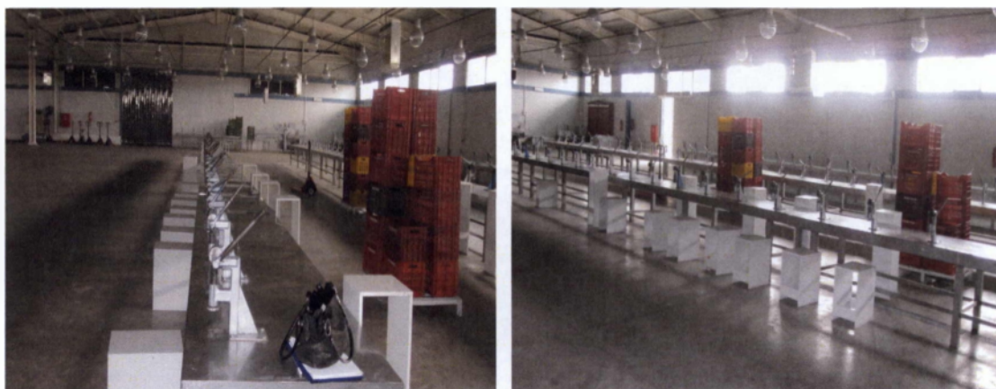
Εικόνα 25: Πάγκοι και χειροκίνητες πρέσες συσκευασίας για ξηραμένα σύκα.
