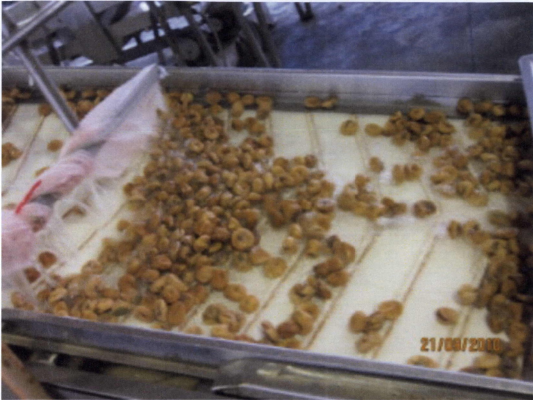
Εικόνα 15: Πρόπλυση ξηραμένων σύκων σε ταινιόδρομο.
