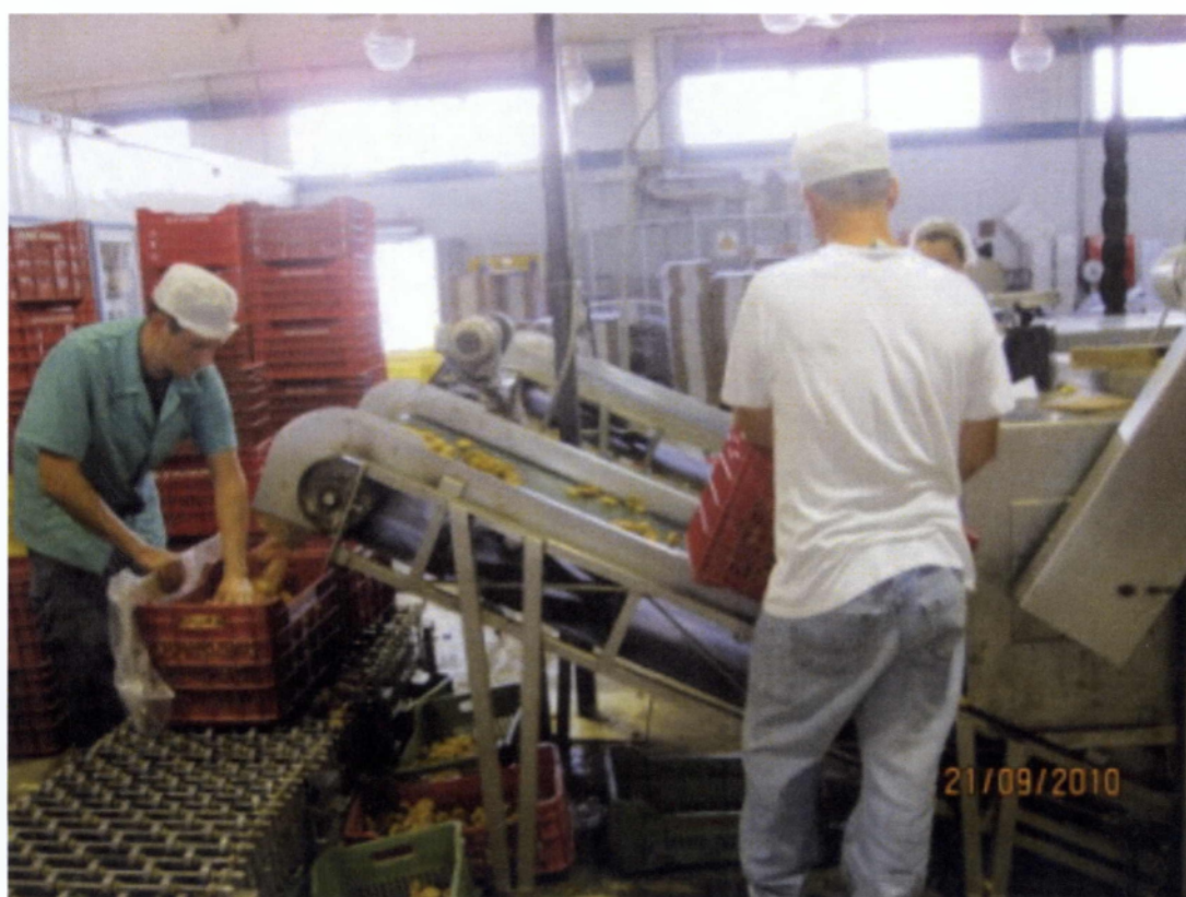
Εικόνα 22: Τοποθέτηση ξηρών σύκων σε πλαστικές κλούβες μετά την έξοδό τους από το βραστήρα.
