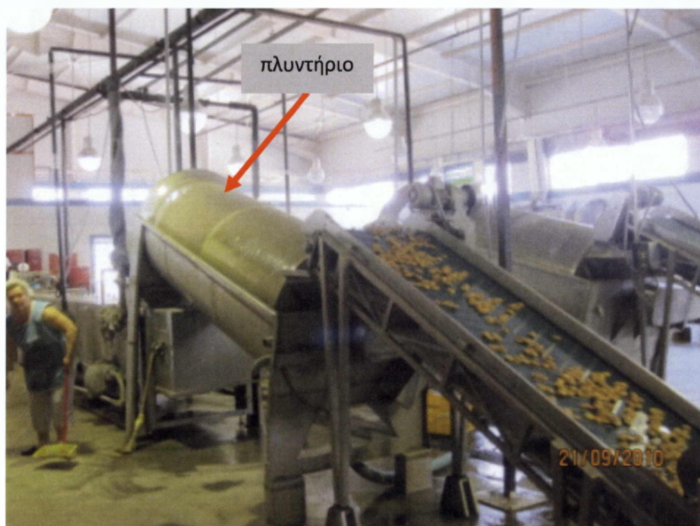
Εικόνα 20: Πλυντήριο κυλινδρικού σχήματος με περιστρεφόμενο κοχλία.
