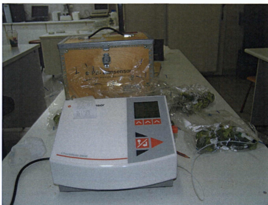
Εικόνα 5: Φορητός αναλυτής O 2 /CO 2 (Model: Check Mate 9900, PBI Dansensor A/S, Denmark).
