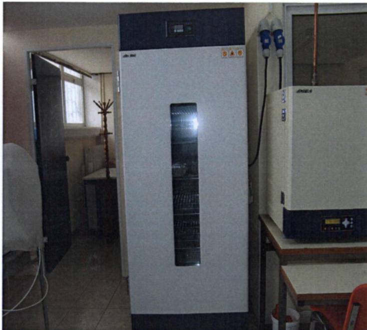
Εικόνα 11: Ξηραντήριο (LabTech DAIHAN LABTECH CO., LTD)
