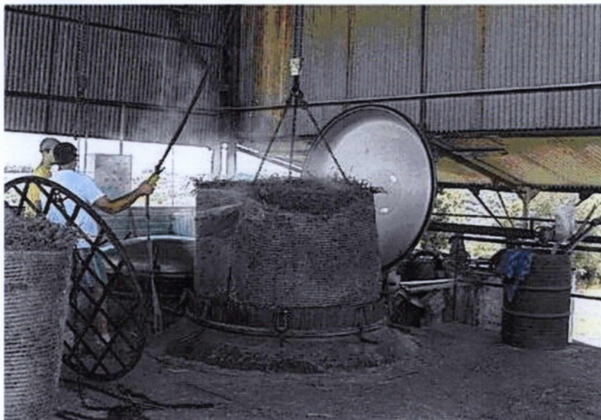
Εικ.4.2.2 απόσταξη σε σταθερό αποστακτήριο.
