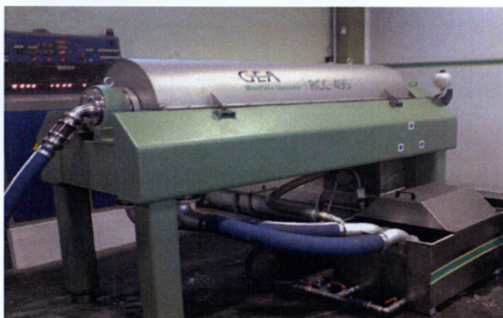
Εικόνα 24: Φυγοκεντρικός διαχωριστήρας εταιρείας westfalia-2008
