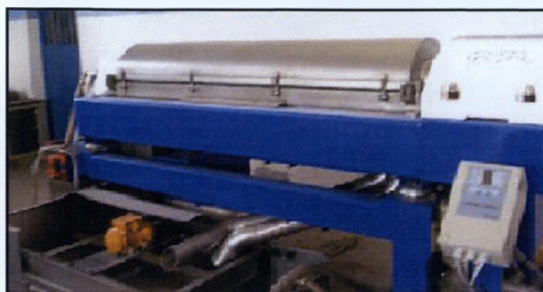
Εικόνα 21.- Διφασικός φυγοκεντρικός διαχωριστήρας (Διαχωριστήρας εταιρείας Westfalia-2007)
