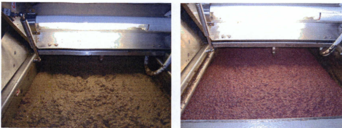
Εικόνα 3.9. Μαλακτήρες με διαφορετική πάστα
