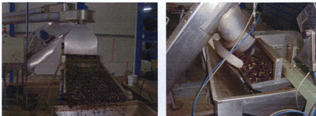
Εικόνα 3.6. Καθαρισμός και πλύσιμο ελαιοκάρπου
