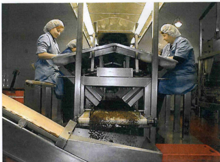
Εικόνα 6.5: Χειροδιαλογή με δονητικό μεταφορέα και ταινία μεταφοράς
