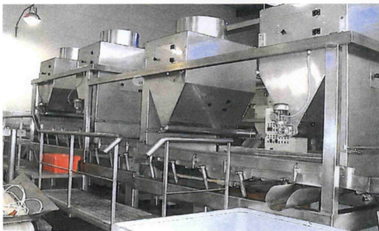
Εικόνα 6.1: Μεγάλη μάκινα με τρεις κοσκίνες και τέσσερις ηλεκτρονικές απορροφήσεις
