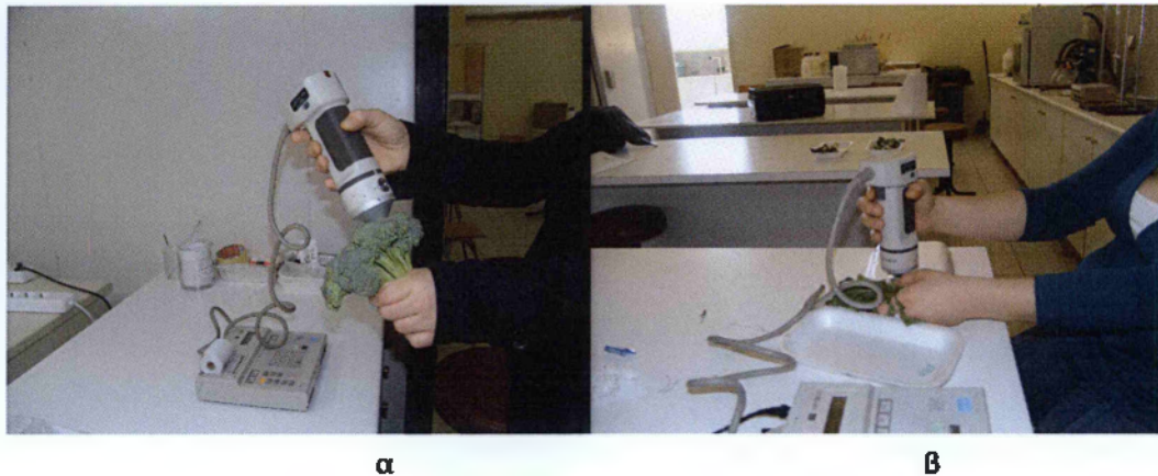
Εικόνα11. Μέτρηση χρώματος με χρωματόμετρο Minolta α)σε κεφαλές μπρόκολου και β) σε φύλλα ρόκας.
