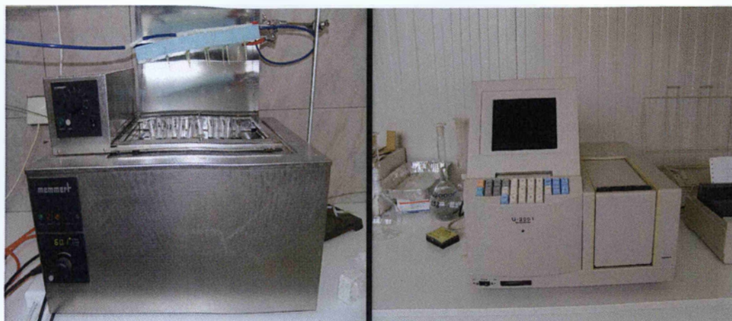
Εικόνα 9. α) Υδατόλουτρο για την επώαση β) φασματοφωτόμετρο για τη μέτρηση της χλωροφύλλης.
