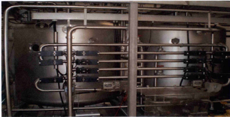
Εικόνα 2.17. Αποπύκνωση,αποδόξυνση του χυμού, μέσω ρητινών
