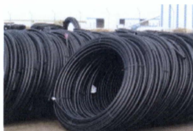
Εικόνα 152 Σωλήνας άρδευσης Ø32
