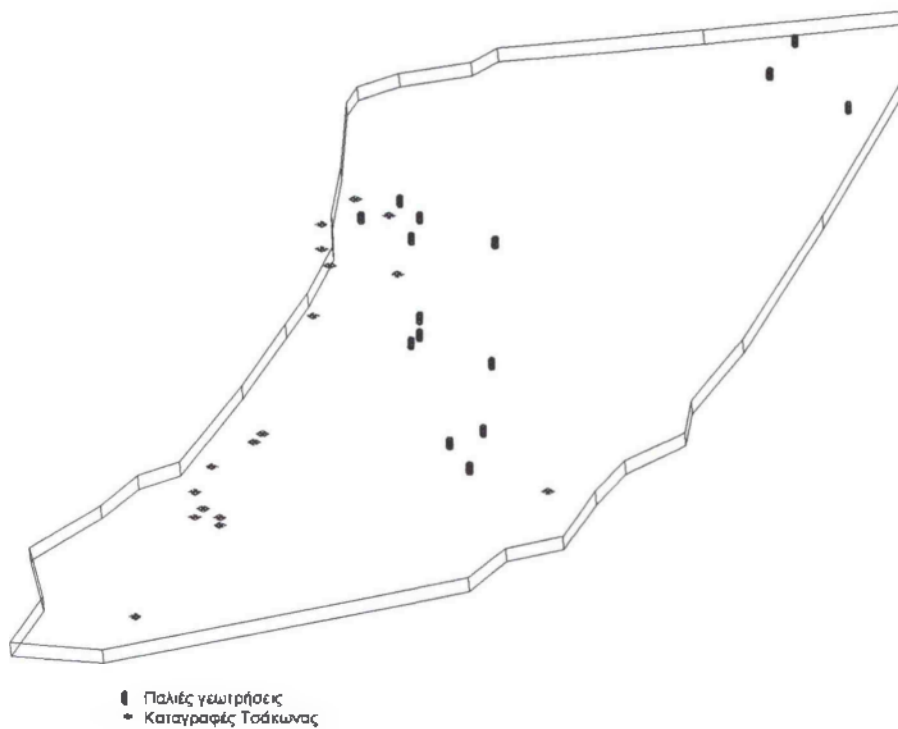
Σχήμα 23: Τρισδιάστατο μοντέλο απεικόνισης της περιοχής Μπούκας με τις θέσεις των γεωτρήσεων σε κάτοψη. Έχει γίνει διαχωρισμός των παλαιών γεωτρήσεων και της καταγραφής των νέων.
