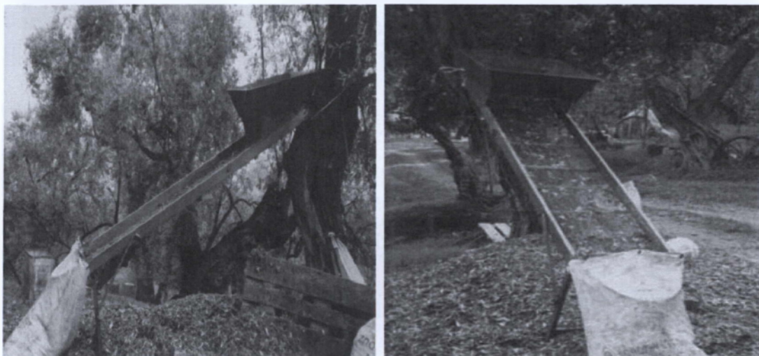
Εικ. 4.9 Μηχάνημα για διαχωρισμό καρπού ελιάς από φύλλα
