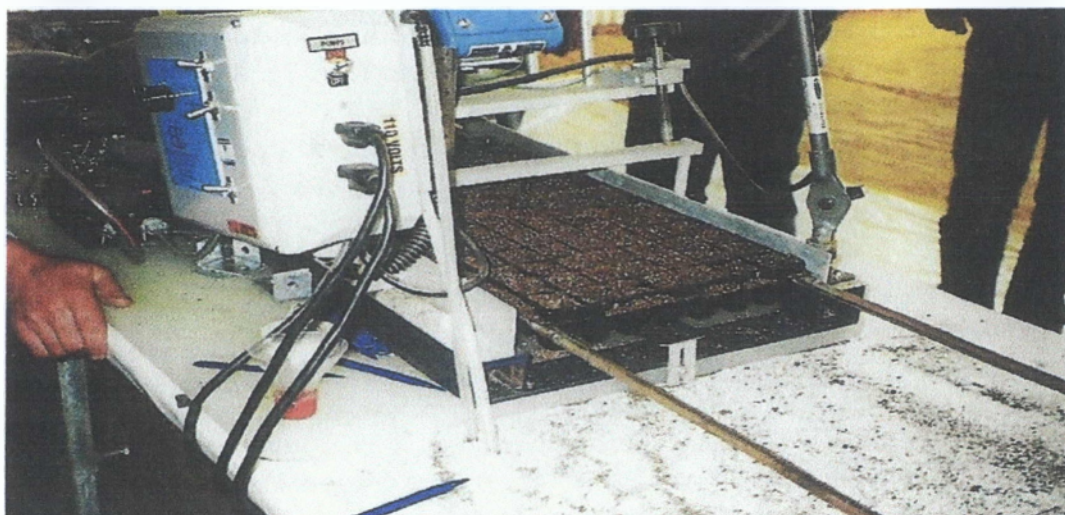
Εικόνα 1. Αυτόματη σπαρτική μηχανή για σπορά σε κυψελίδες πλαστικών δίσκων
