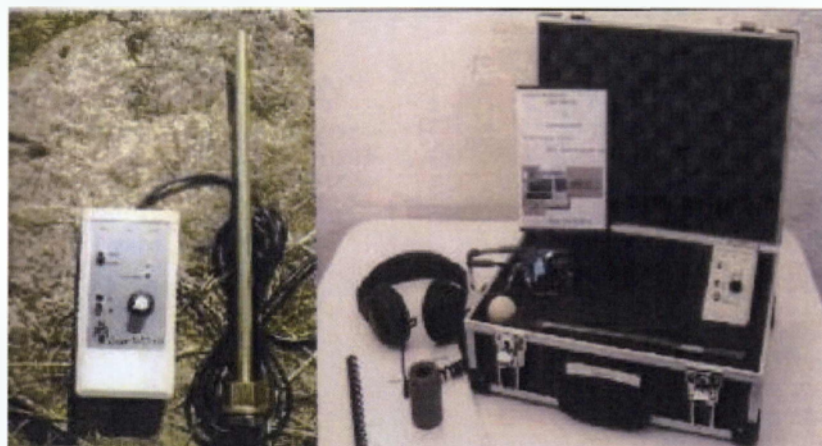
Εικόνα 17: Σύσκευή βιοακουστικής ανίχνευσης
