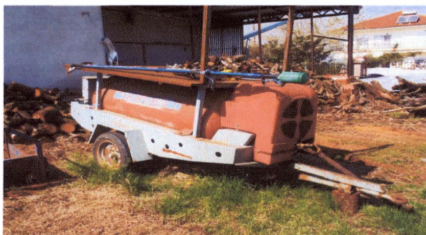
Εικόνα 3.3: Συρόμενο κλαδευτικό μηχανήμα με αεροσυμπιεστή.
