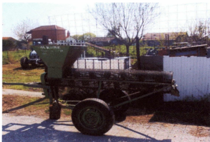
Εικόνα 5.2: Αποφλοιωτική μηχανή διαχωρισμού του σαρκώδους περικαρπίου.
