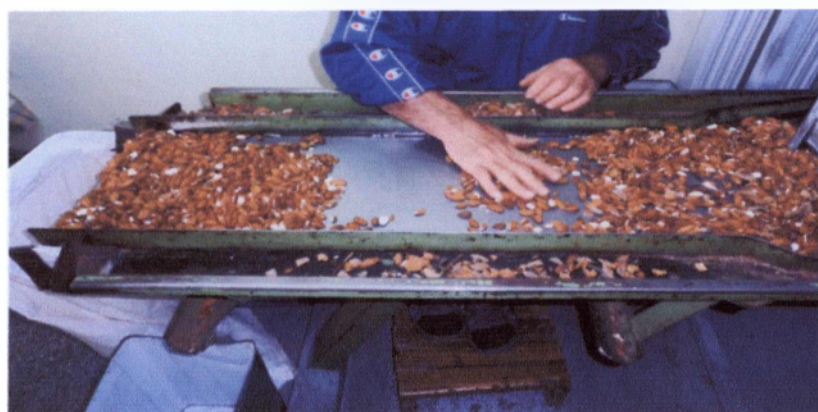
Εικόνα 5.4: Δονούμενο τραπέζι διαλογής αμυγδάλου.
