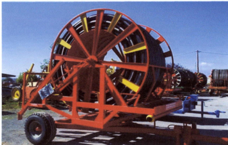
Εικόνα 3.6: Καρούλι ποτίσματος με καταιονισμό.
