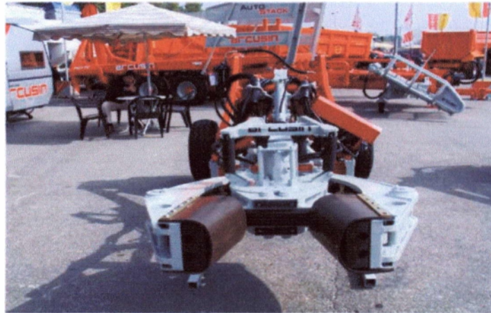
Εικόνα 5.1: Δονητής συγκομιδής αμυγδάλων. Ο ίδιος δονητής χρησιμοποιείται και στην συγκομιδή ελιάς.
