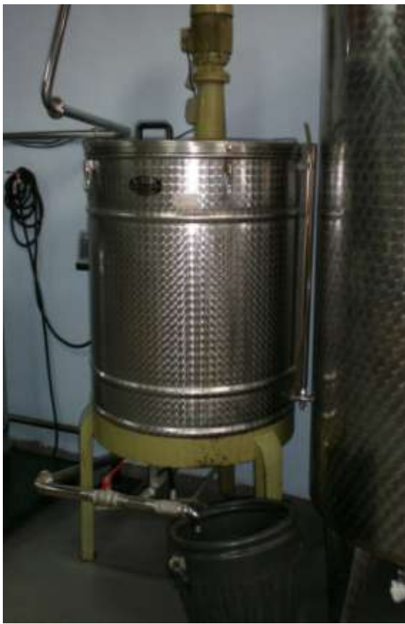
Εικόνα 1: Δεξαμενή αποστάγματος (Πηγή: Κωστέας)
