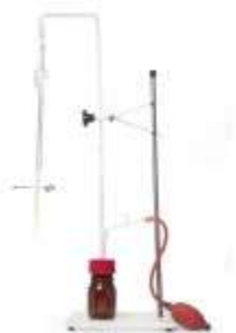
ΕΙΚΟΝΑ 45. Ογκομέτρηση με τη μέθοδο Dornic
