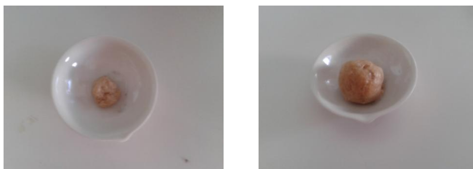
Εικόνα 3.2: Δείγμα αλεύρου ζέας στη μέτρηση ικανότητας ενυδάτωσης γλουτένης. Αριστερά φαίνεται το δείγμα πριν την ξήρανση, ενώ δεξιά μετά την ξήρανση.
