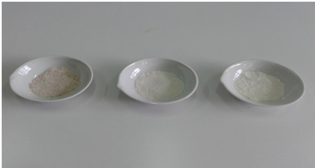
Εικόνα 7: Η κάψες πορσελάνης στις οποίες ζυγίζονται και ξηραίνονται σε κλίβανο τα άλευρα (Ολικής Άλεσης, Τύπου 70%, Τύπου Αμερικής)
