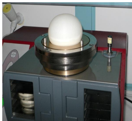
Εικόνα 14: Η ζύμη κατά τη διάρκεια της διοχέτευσης αέρα στο τμήμα διόγκωσης του αλβεογράφου. Διακρίνεται και ο θάλαμος σταθερής θερμοκρασίας στον οποίο αφήνονται τα δισκία ζυμαριού για 20 min.
