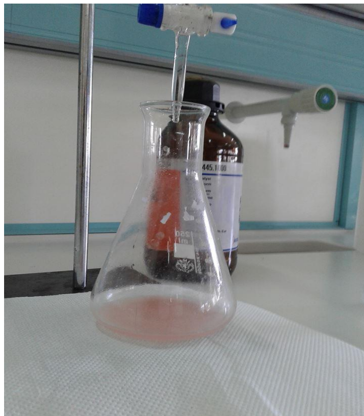
Εικόνα 6: Η τιτλοδότηση του δείγματος με KOH 0.02 N ολοκληρώνεται όταν το δείγμα πάρει αυτήν την ανοιχτή ροζ απόχρωση.
