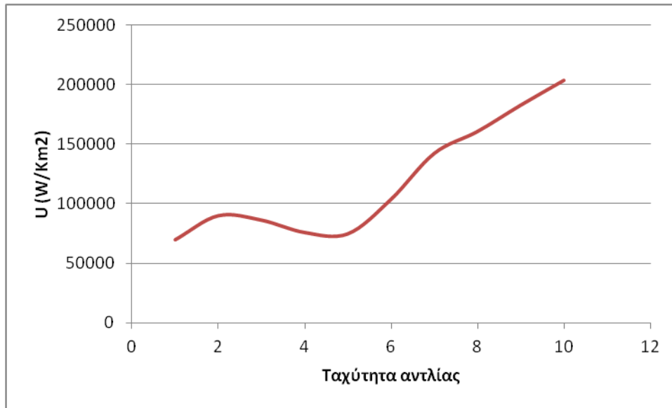
Διάγραμμα 21. Μεταβολή του ολικού συντελεστή μετάδοσης θερμότητας σύμφωνα με την ταχύτητα της αντλίας.
