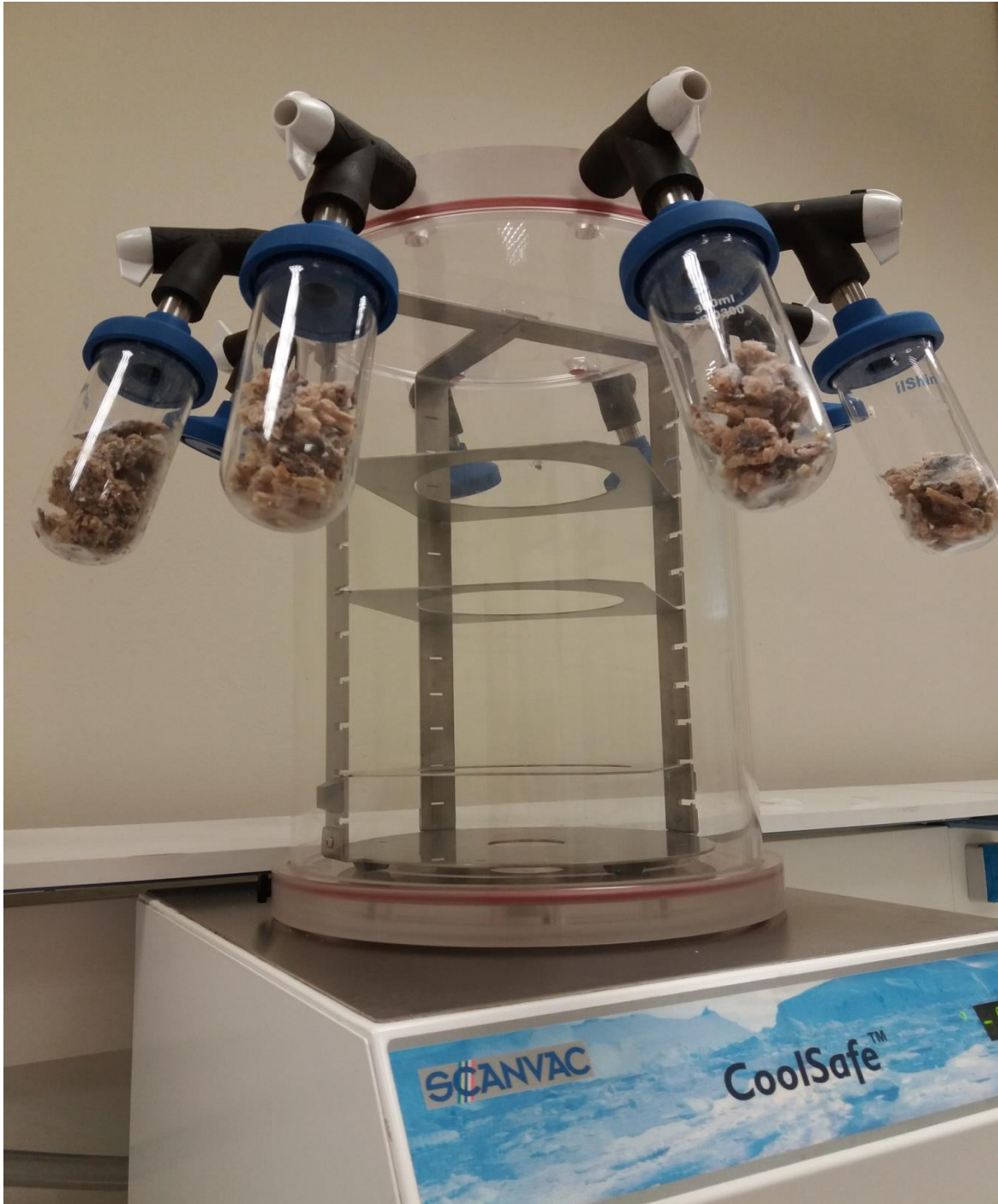
Εικόνα Α1. Λυοφιλίωση δειγμάτων σαρδέλας.
