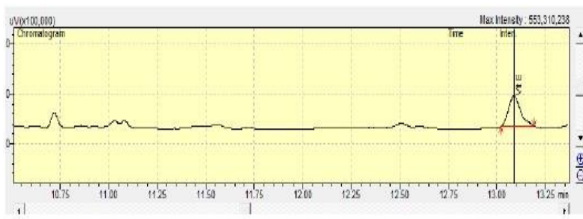
Εικόνα 39: Χρωματογράφημα προσδιορισμού α-τοκοφερόλης δείγματος Ιουνίου.
