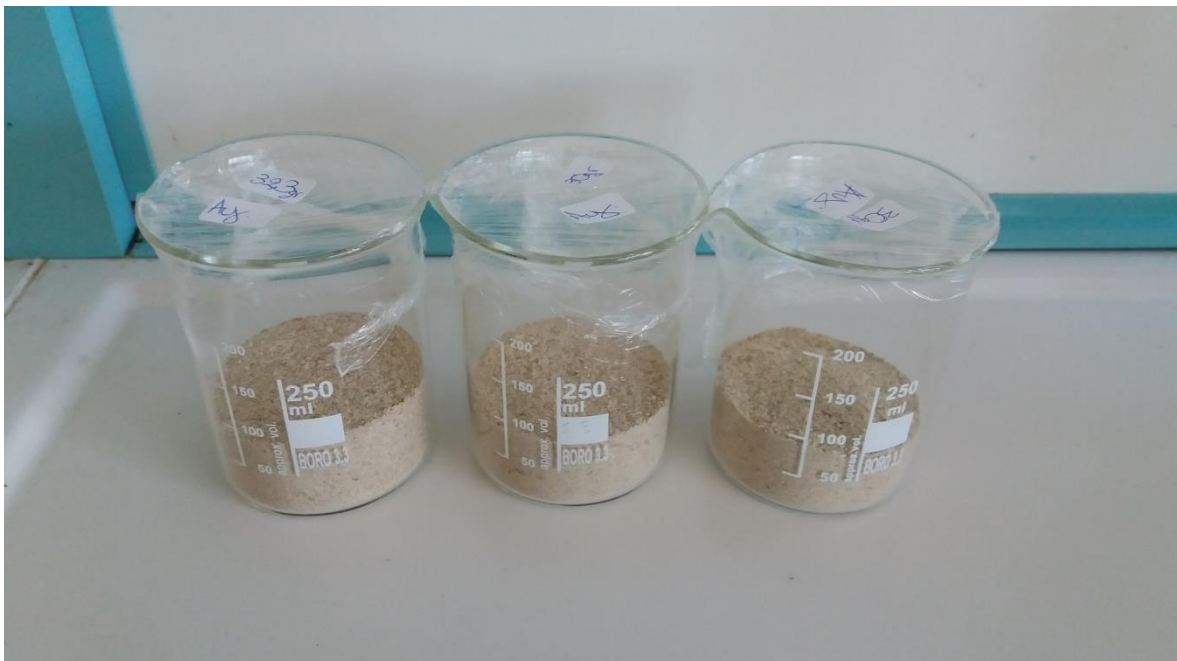
Εικόνα Α3. Θρυμματισμένο δείγμα μετά την λυοφιλίωση.
