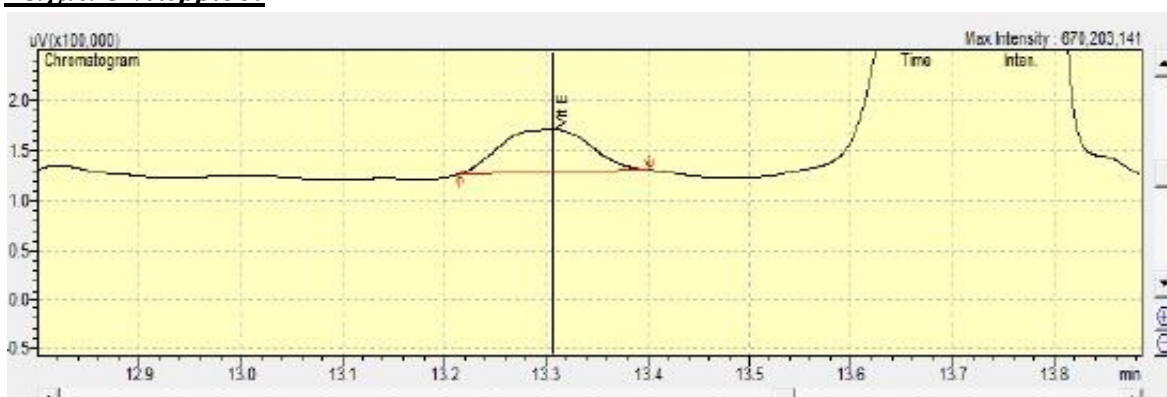
Εικόνα 43: Χρωματογράφημα προσδιορισμού α-τοκοφερόλης δείγματος Οκτωβρίου.
