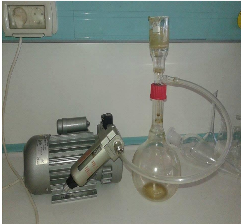
Εικόνα 19: Μηχάνημα διήθησης υπο κενό Büchner σε λειτουργία
