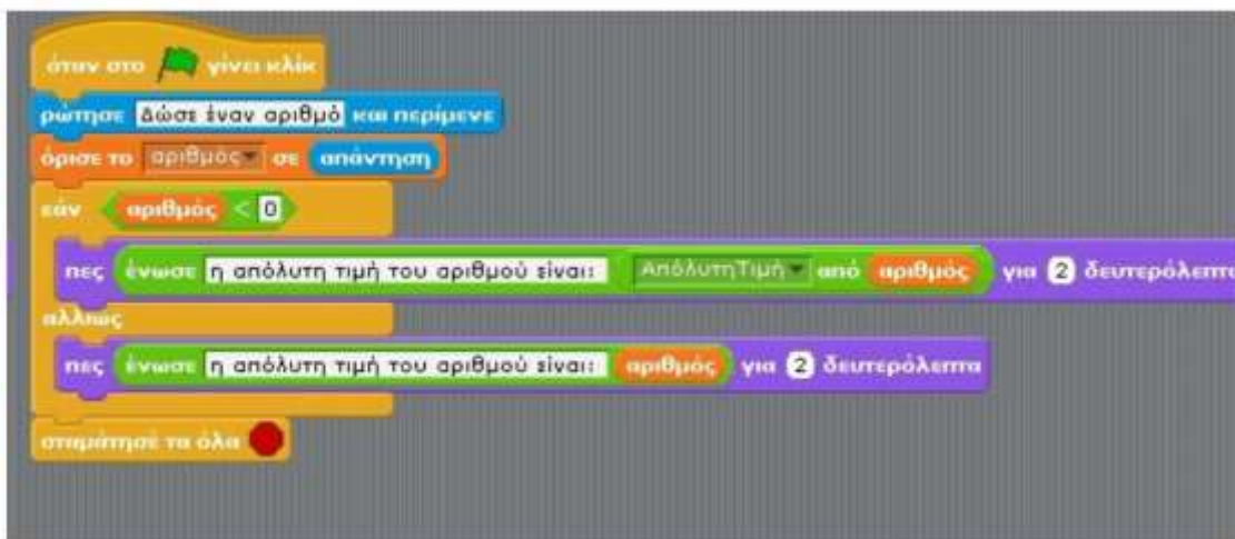
Εικόνα 12 Διάγραμμα ροής και εφαρμογή δομής επιλογής στο Scratch
