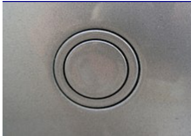
Εικόνα 24: Υπερηχητικός αισθητήρας στάθμευσης
