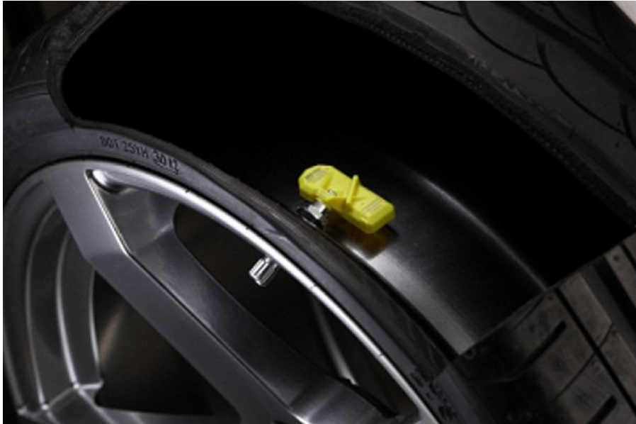
Εικόνα 34: Εσωτερικός αισθητήρας πίεσης ελαστικού
