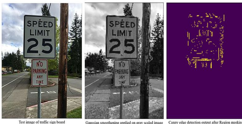
Εικόνα 22: Παράδειγμα εφαρμογής των βημάτων προεπεξεργασίας εικόνας στον αλγόριθμο ανίχνευσης κυκλοφοριακών σημάτων
