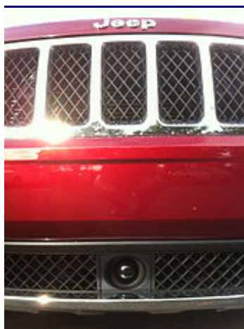
Εικόνα 6: Ο αισθητήρας Ρανταρ του προσαρμοστικού ελέγχου ταχύτητας του Jeep που βρίσκεται στο κέντρο της κάτω γρίλιας.
