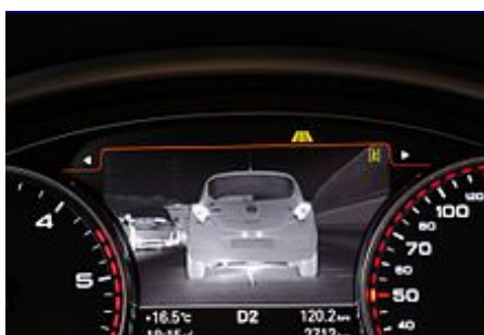
Εικόνα 43: Audi A8 Βοηθός νυχτερινής όρασης
