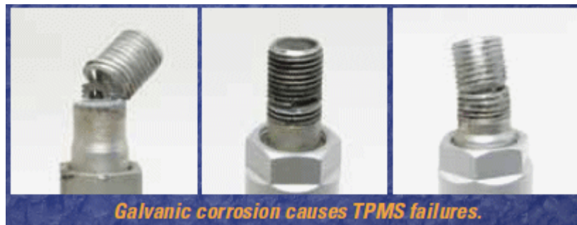
Εικόνα 39: Αποτυχία TPMS λόγω Γαλβανικής διάβρωσης
