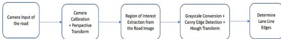
Εικόνα 16: Αλγόριθμος ανίχνευσης λωρίδας
