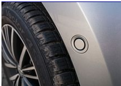
Εικόνα 25: Αισθητήρας στάθμευσης σε ένα φτερό αυτοκινήτου
