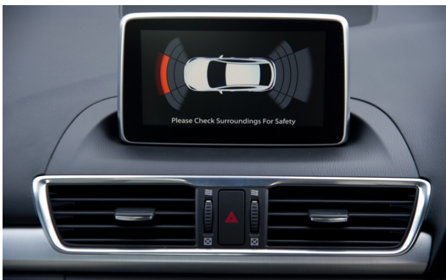
Εικόνα 26: Εικονόγραμμα αισθητήρων παρκαρίσματος οχήματος στην οθόνη ψυχαγωγίας του αυτοκινήτου
