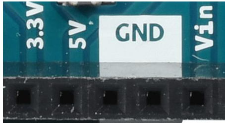
Εικόνα 26 – Είσοδος ονομασίας Vin για τροφοδοσίας του μικροελεγκτή Arduino UNO
