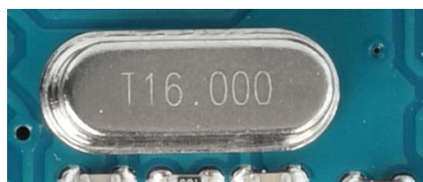
Εικόνα 23 – Ταλαντωτής κρυστάλλου των 16.000 KHz του μικροελεγκτή Arduino UNO
