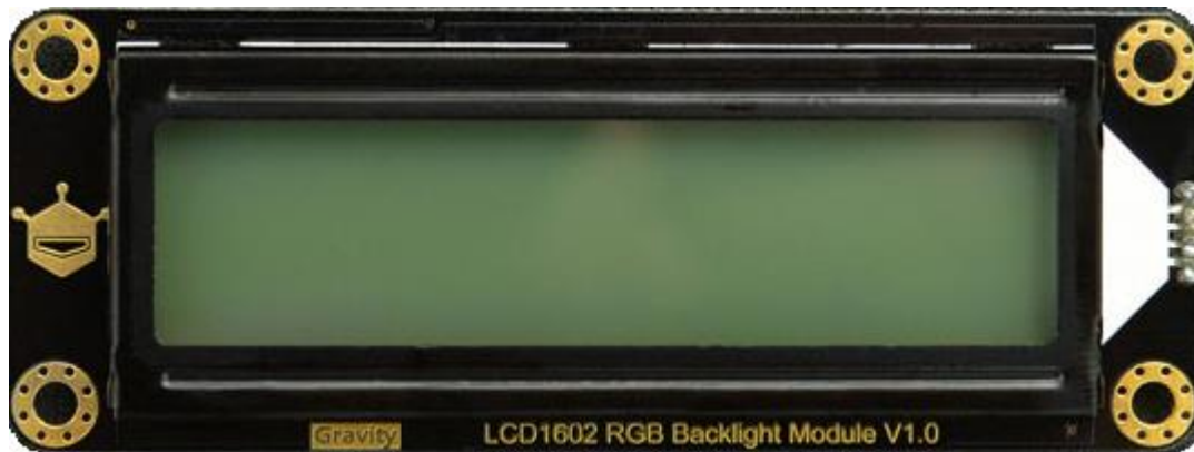
Εικόνα 41 – Μπροστινή όψη οθόνη τύπου LCD 16x2
