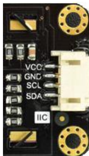
Εικόνα 42 – Οπίσθια όψη οθόνης και υποδοχή σύνδεσης
