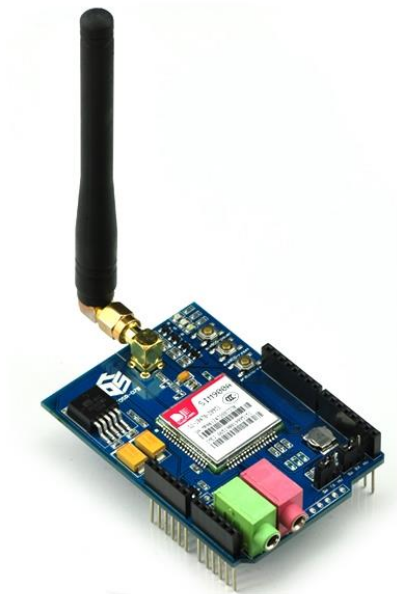
Εικόνα 13 – Ασπίδα σύματος κινητών επικοινωνιών GPS/GPRS
