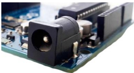
Εικόνα 21 – Στρογγυλό βύσμα τροφοδοσίας (τύπου Jack) του μικροελεγκτή Arduino UNO
