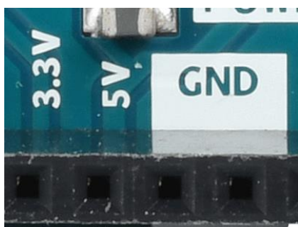
Εικόνα 25 – Είσοδος παροχής ηλεκτρικής τάσης και γείωσης του μικροελεγκτή Arduino UNO
