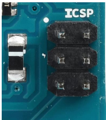
Εικόνα 28 – Ακροδέκτης ICSP του μικροελεγκτή Arduino UNO
