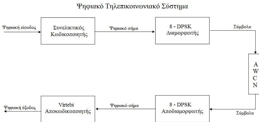
Εικόνα 31 - Ψηφιακό Τηλεπικοινωνιακό Σύστημα
