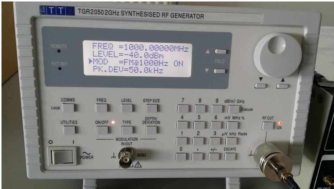
Εικόνα 51 : Έξοδος Σήματος FM
