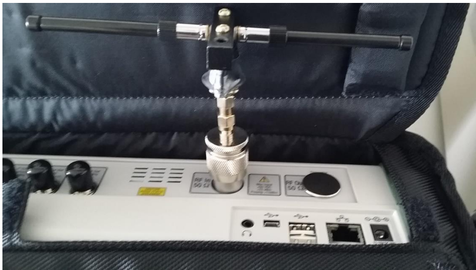
Εικόνα 30 : Κεραία συνδεδεμένη στον αναλυτή
