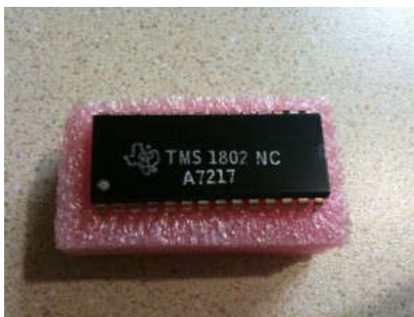
Εικόνα 2. 1 Chip TMS-1802-NC Ολοκληρωμένο κύκλωμα μικροελεγκτή
