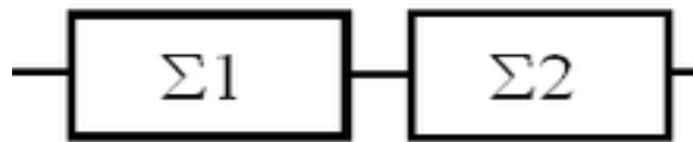
Σχήμα 6 Συσκευές συνδεδεμένες σε σειρά στο κύκλωμα. [5]
