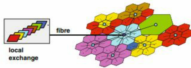
Εικόνα 23 Δυναμική Αναδιάρθρωση με ευέλικτη πολυπλεξία WDM
