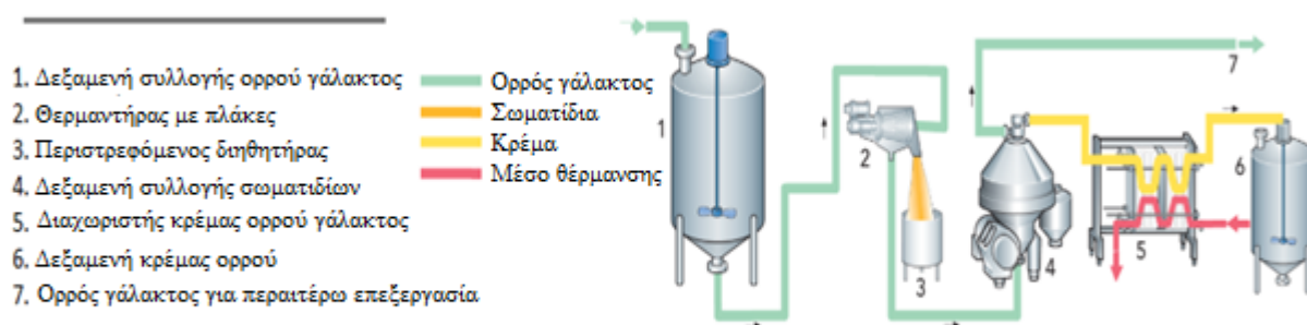
Σχήμα 3.1. Διαχωρισμός λίπους και σωματιδίων ορρού γάλακτος (Tetrapak, 2015).
