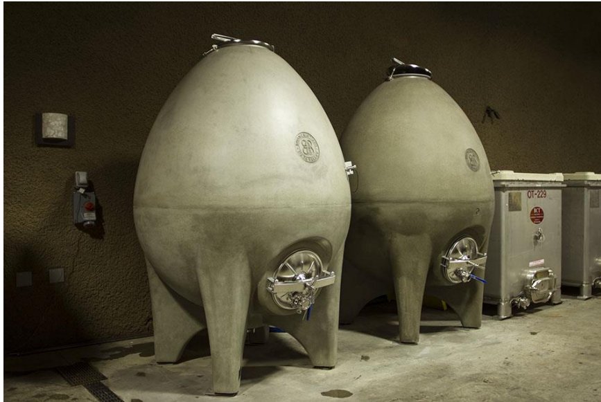
Εικόνα 30: Μικρές τσιμεντένιες δεξαμενές που χρησιμοποιούνται για την παλαίωση των κρασιών
