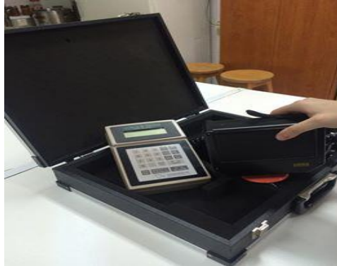
Εικόνα 5.2: Χρωματόμετρο ( Handy Colour Testers, Model: H-CT, No CC 1139, Suga Test Instruments Go.Ltd, China)
