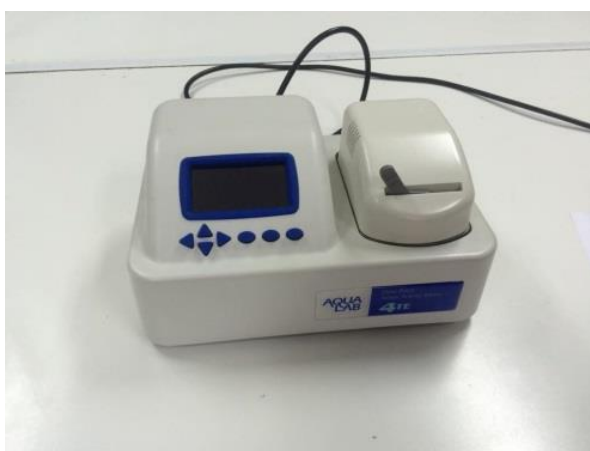
Εικόνα 5.1: Συσκευή μέτρησης ενεργότητας ύδατος (Dew Point Water Activity Meter 4te, Aqua Lab, Decagon Devices, SN: S4003963, made in USA)
