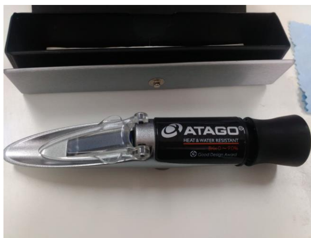
Εικόνα 5.4: Διαθλασίμετρο χειρός (ATAGO MASTER SERIES REFRACTOMETER MASTER-500)
