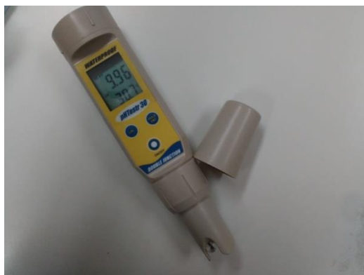
Εικόνα 5.3: pHμετρο EUTECH INSTRUMENTS pHTestr 30
