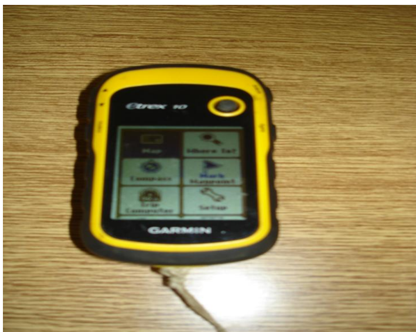
Εικόνα 10. Συσκευή εντοπισμού GPS e trex 10. Προσαρμογή από το Γραφείο Αγροτικής Οικονομίας Λεωνιδίου.
