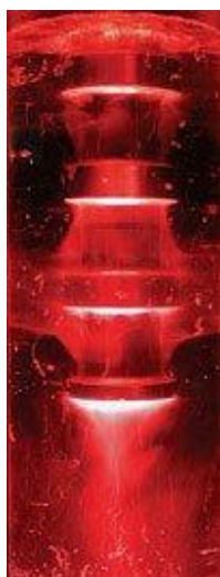
Εικόνα 10: Φαινόμενο σπηλαίωσης με υπερήχους
