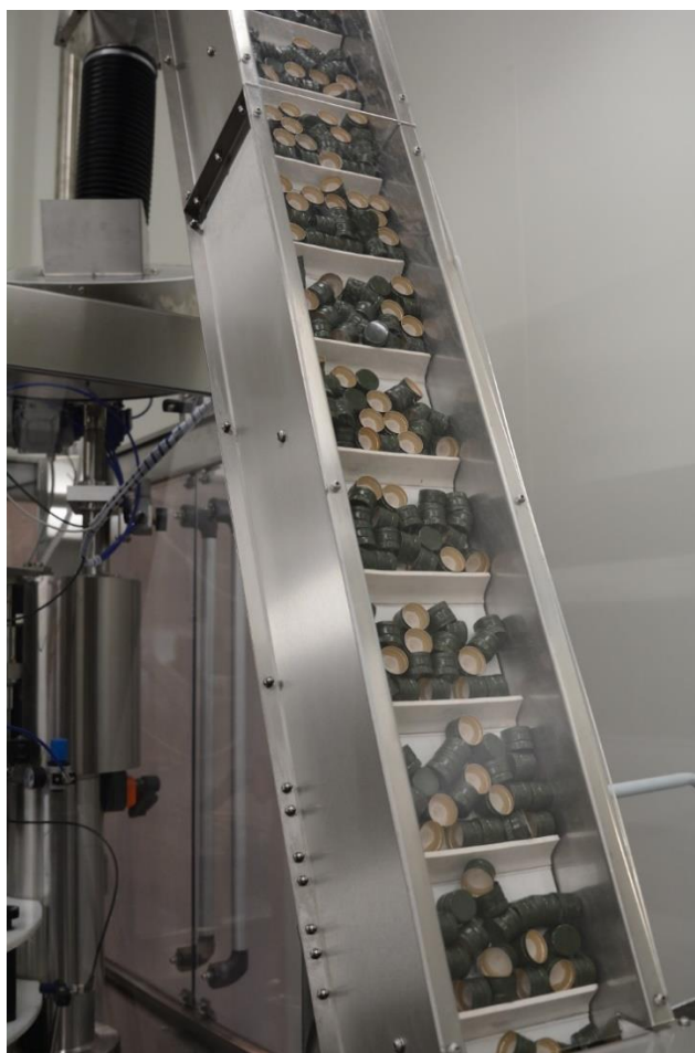
Εικόνα 20 Αναβατήριο πωμάτων προς την μηχανή πωματισμού (OLYMPIAN GREEN)
