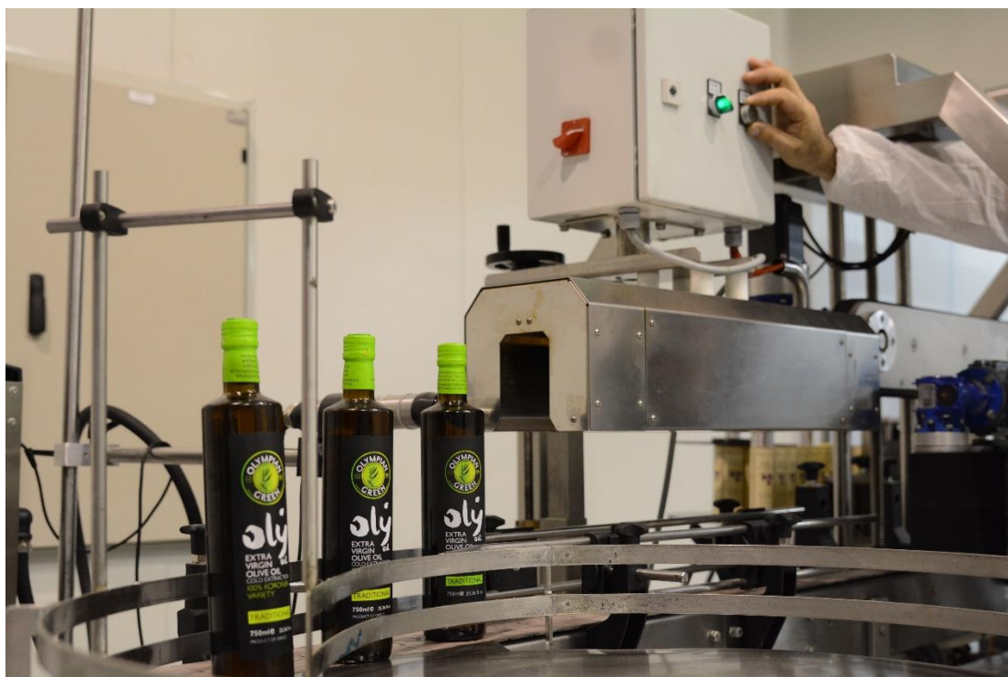
Εικόνα 22 Σήραγγα συρρίκνωσης καψυλίων (OLYMPIAN GREEN)
