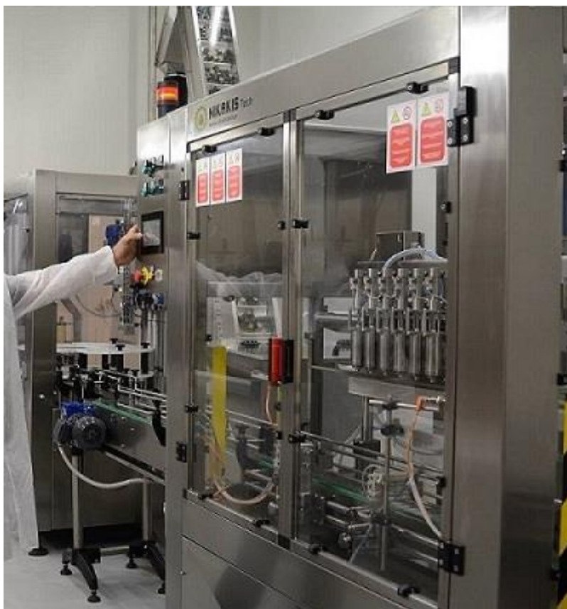
Εικόνα 18 Μηχανή πλήρωσης συσκευασιών (OLYMPIAN GREEN)
