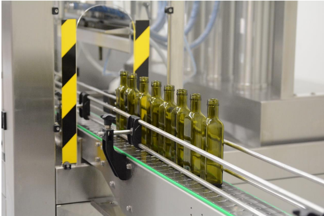
Εικόνα 17 Ταινία μεταφοράς συσκευασιών και πλαϊνοί οδηγοί προσανατολισμού (OLYMPIAN GREEN)
