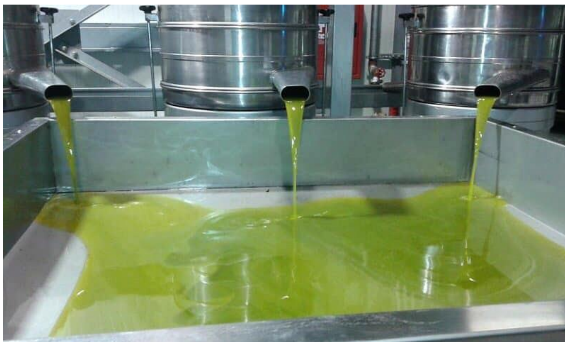
Εικόνα 11 Εξαγωγή ελαιόλαδου από τους διαχωριστήρες (OLYMPIAN GREEN)
