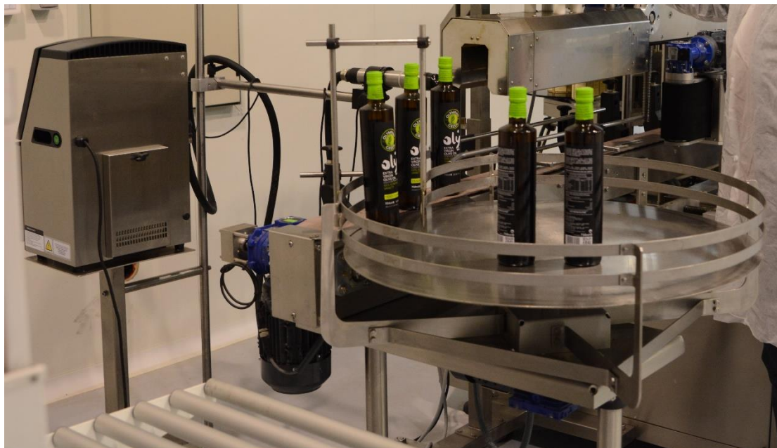
Εικόνα 23 Τραπέζι συλλογής έτοιμων συσκευασιών (OLYMPIAN GREEN)
