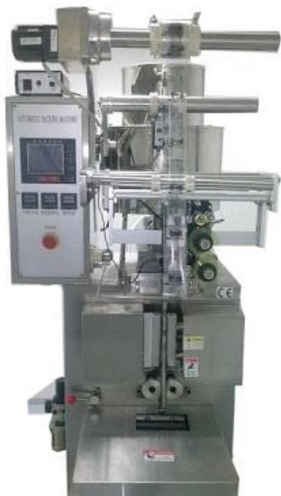
Εικόνα 25 Μηχανή για την παραγωγή ελαιόλαδου σε συσκευασία stick
