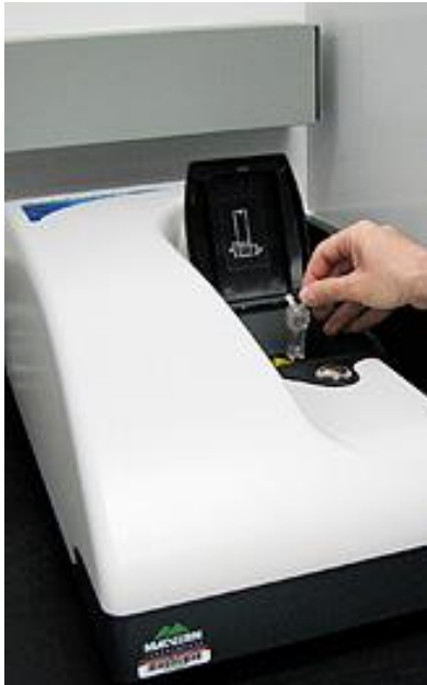
Εικόνα 5: Τοποθέτηση δείγματος στον Malvern Zetasizer Nano ZS ZEN3600
