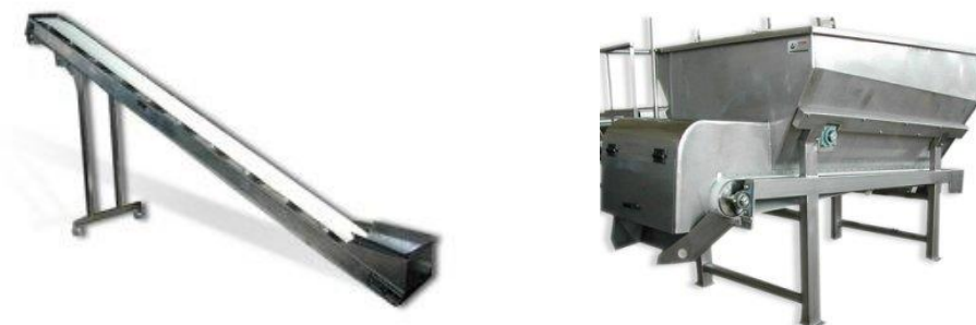
Εικόνα 10: Μεταφορική ταινία και αυτόματος τροφοδότης με σπαστήρα σβόλων (Εταιρεία παραγωγής αυτόματων μηχανημάτων για επεξεργασία και συσκευασία σταφίδων)
