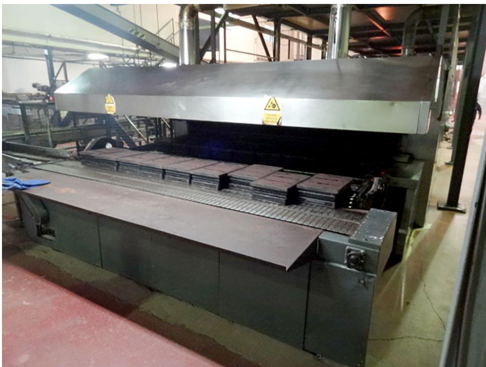
Εικόνα 5 : Φούρνος αρτοποιίας ( https://dubet.com/equipment/ )
