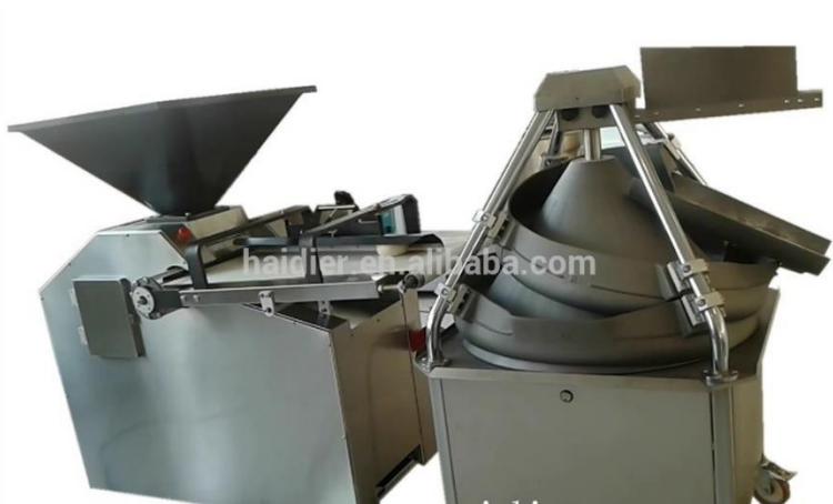
Εικόνα 2: τεμαχισμός (ντίβα αριστερά) και μορφοποίηση (κώνος δεξιά) ζυμαριού ( https://dubet.com/equipment/ )
