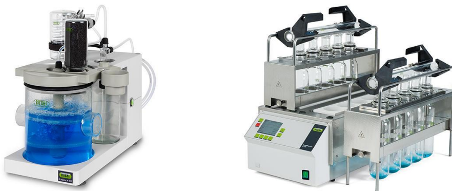
Εικόνα 6.6.2. Σύστημα απαγωγού αερίων-εστία θερμάνσεως φιαλών πέψης
