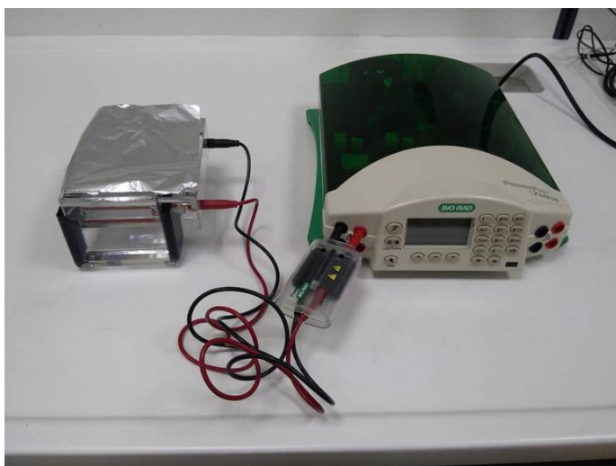
Εικόνα 3.2: Συσκευή ηλεκτροφόρησης πρωτεϊνών
