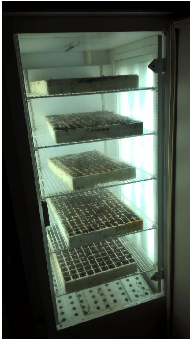
Εικόνα 1.7: Τοποθέτηση των δίσκων σε θάλαμο ελεγχόμενων συνθηκών.
