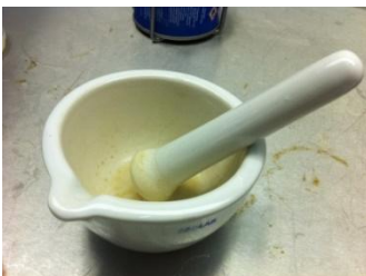
Εικόνα 4: Αποστειρωμένο ιγδίο πορσελάνης για την λειοτριβήση των φυτικών ιστών μέσα στο θάλαμο νηματικής ροής ακτινοβολίας UV
