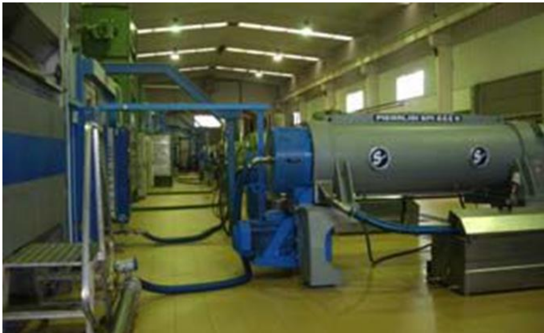
Εικόνα 12 Διαχωρισμός ελαίου και νερού με φυγοκεντρικό μηχάνημα
