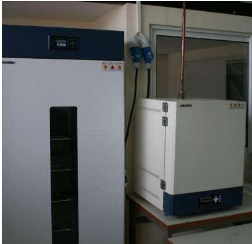
Φωτογραφία 4: Ξηραντήριο (αριστερά), Κλίβανος αποτέφρωσης (δεξιά)
