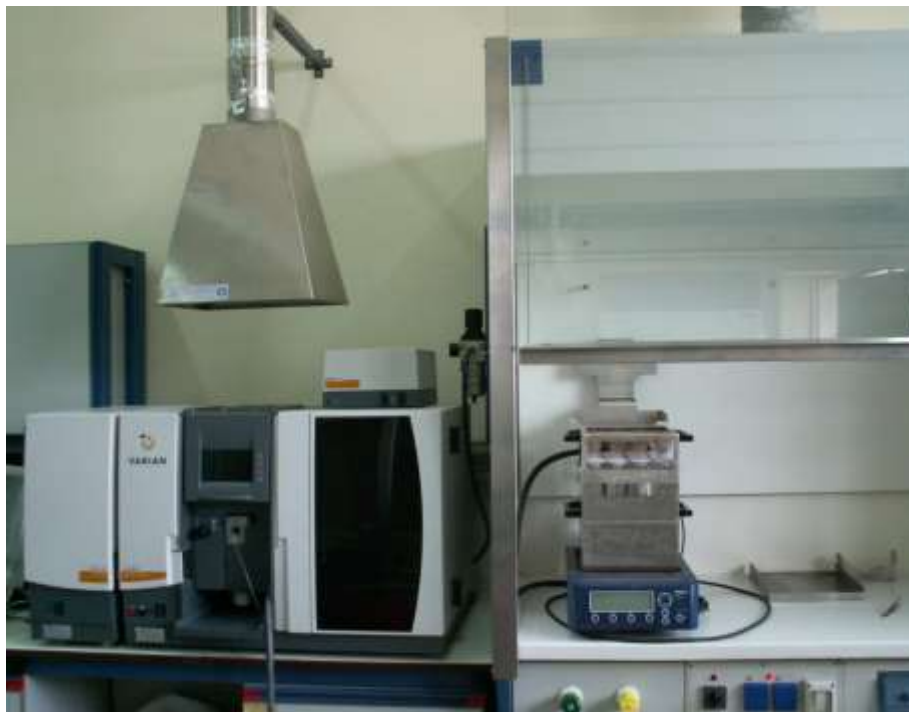
Φωτογραφία 5: Σπεκτροφωτόμετρο Ατομικής Απορρόφησης (αριστερά), Συσκευή Υγρής Καύσης (δεξιά)
