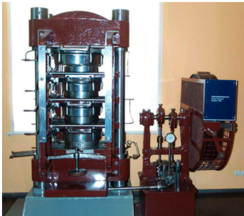
Εικ. 3.1. Αντίγραφο πρώιμης υδραυλικής πρέσας [44]
