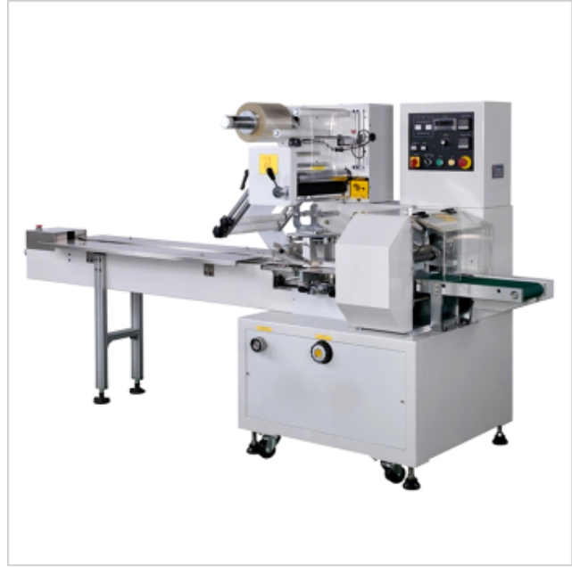
Εικ. 6.6. Τυπική μηχανή flow-wrap [69]
